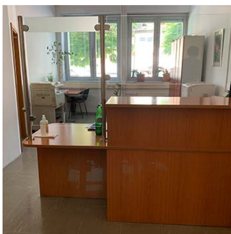
Slika 49:Primeri slabe in dobre prakse ureditve pulta – zlasti višinske prilagoditve za omogočanje čelnega dostopa.
